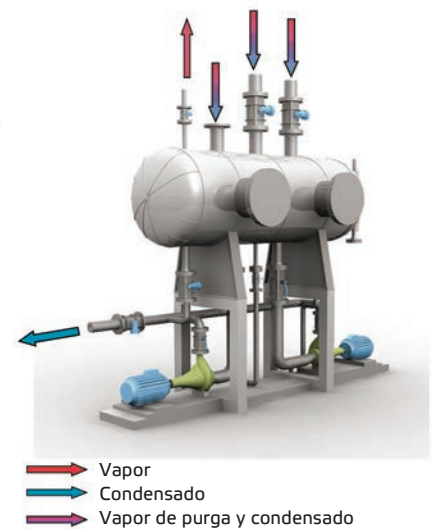
Figura 16. Tanque de condensados durante una situación de funcionamiento normal
