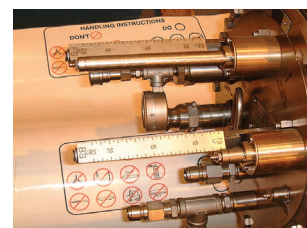
Figura 16. Una mirada a la escala removible de Valmet mostrará al operador la posición exacta de la cubierta del extremo.
