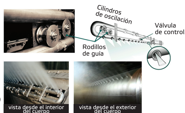
Figura 11. Un sistema de enjuague oscilatorio de limpieza de alta presión en funcionamiento.
