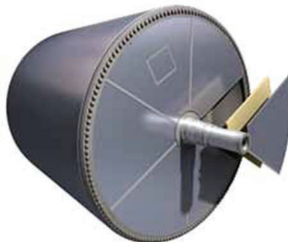
Figura 9. El aislamiento de la cabeza Yankee es una medida eficiente para ahorrar energía
