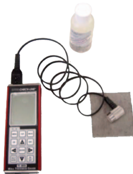
Figura 5. Cuando solo se tiene acceso a un lado de la estructura, se utiliza un calibrador ultrasónico de espesor de pared.
