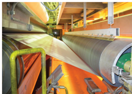
Figura 1. iRoll instalado en una aplicación de medición de tensión.
