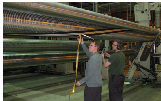
Figura 5. Instalación de sensores portátiles de medición en la superficie de un rodillo.
