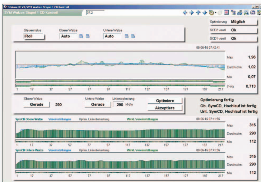
Figura 9. Interfaz de medición y control de iRoll usada en Plattling-Papier PM1.
