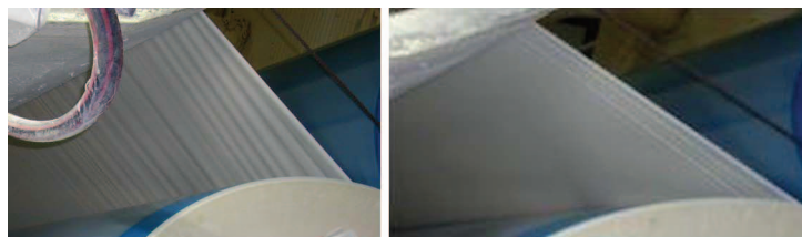
Figura 2. Control iRoll apagado (izquierda) y encendido (derecha)
