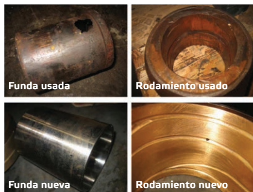
Figura 15. Rodamientos de la viga del separador de rodillo central, usados, contra nuevos
