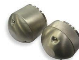
Figura 15. Rodamientos de la viga del separador de rodillo central, usados, contra nuevos
