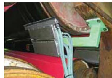
Figura 14. Las unidades TailDoc de hilado de colas llevan éstas a través de la línea PM2 de LWC por medio de aire comprimido.
