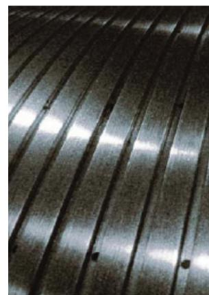
Figura 3. Los VacRolls ondulados y perforados mejoran el comportamiento en los grupos de secadores de un solo fieltro.
