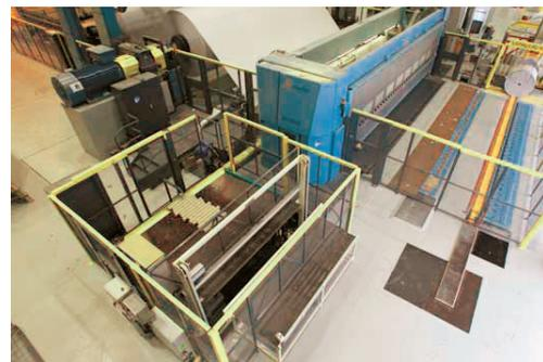
*Figura 1. Debido al alto nivel de automatización, el nivel de protección en las máquinas de Metso es alto. La seguridad ha sido integrada en los controles y diseño de la máquina.*
