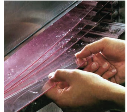
Figura 2. Las Polysheets están hechas de policarbonato (Lexan)
