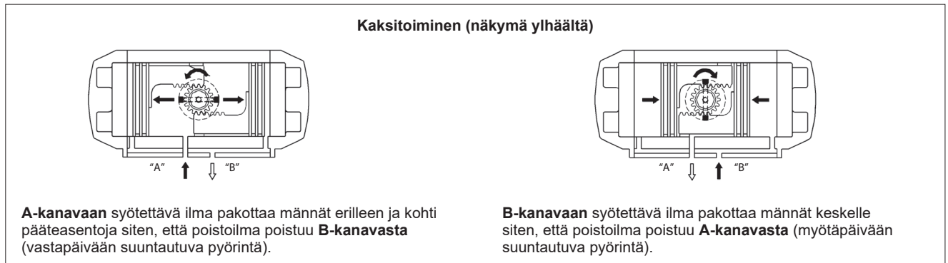
Kuva 1. Kaksitoimisen mallin toimintaperiaate
