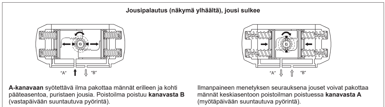
Kuva 2. Jousi sulkee -version toimintaperiaate
