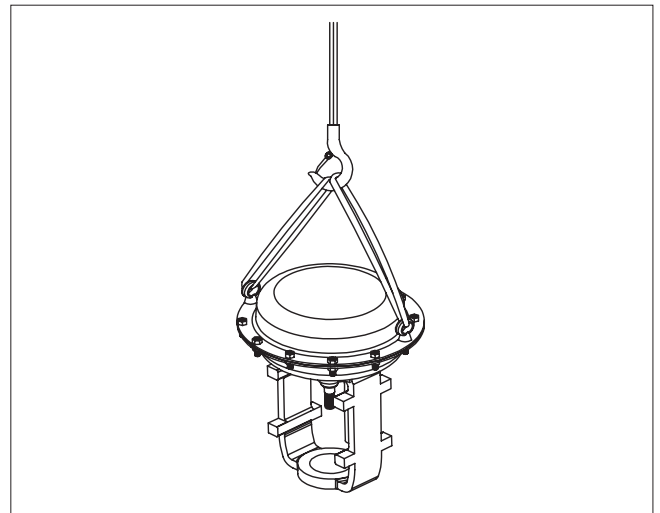
Rys. 4 Podnoszenie kompletnego zaworu i siłownika
