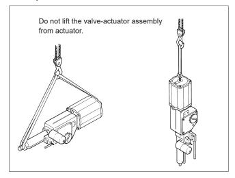
Fig. 6 Lifting the actuator
