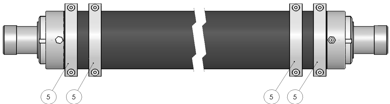
Abbildung 17. Den Flansch für den Pulsationsschlauch und die Schlauchschellen anbringen.
