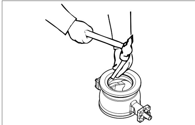
Fig. 22 Dégagement du siège par martelage
