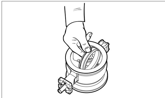
Fig. 23 Extraction du siège hors du corps
