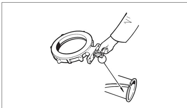
Obr. 16 Inštalovanie štandardných ložísk
