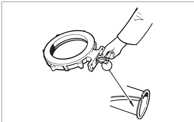
Fig. 16 Montage de paliers standards
