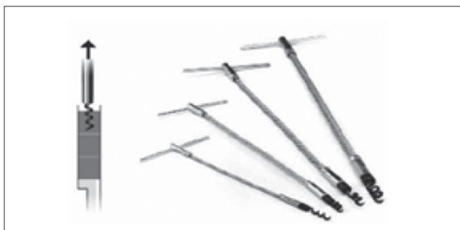
Fig. 13 Herramienta típica de extracción de empaquetadura del prensaestopas
