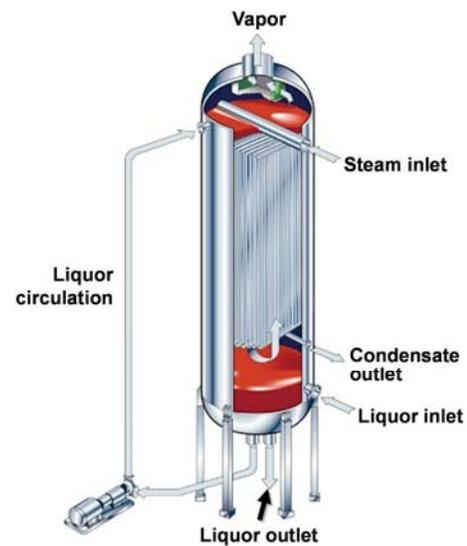
Figure 7. TUBEL<sup>®</sup> falling film
