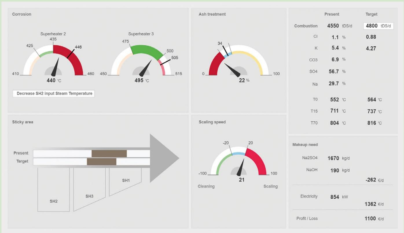
↑ O Valmet Ash Balance Advisor calcula o risco de corrosão e informa a quantidade de cinzas a ser tratada ou descartada. Ele também determina os custos associados com a renovação de sódio. Isso é comparado à perda de produção de eletricidade se, em vez disso, a temperatura do vapor principal for reduzida. A ação de controle pode então ser feita com base no menor custo operacional possível.
