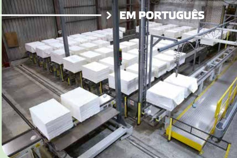
A mudança da remoção manual de amarras de fardos de celulose para um sistema completamente automático de remoção de amarras e manuseio de receitas trouxe outra perspectiva à alimentação do pulper em lotes da InnovioPapers, uma fábrica de celulose em Nijmegen, na Holanda.
